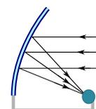
La propiedad focal de la parábola también se usa para el diseño de los focos de los automóviles, en este caso se debe usar un lente para desviar la luz de tal manera que no afecte a los conductores que vienen de frente,
