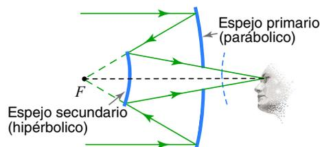
Figura 1.17: Telescopio Cassegrain.
