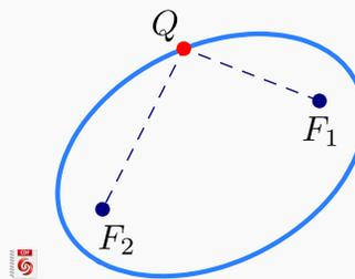
**Propiedad focal de la elipse.** La elipse también tiene una “propiedad focal” análoga a la de la parábola: La normal a la elipse en cualquier punto  $Q$  de la elipse forma ángulos iguales con el segmento  $F_1Q$  y el segmento  $F_2Q$
