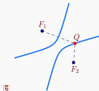
**Propiedad focal de la hipérbola.** La hipérbola también tiene una “propiedad focal” análoga a la de la elipse y la parábola: *La normal a la hipérbola en cualquier punto  $Q$  de la hipérbola, forma ángulos iguales con el segmento  $F_1Q$  y el segmento  $F_2, Q$*
