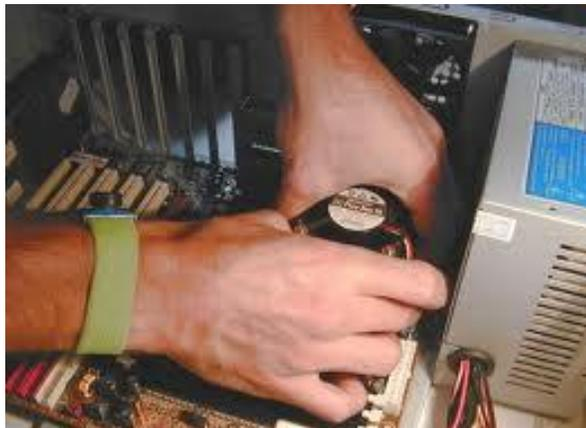
13. Después de retirar el Disipador de Calor, Desaseguramos las palancas que sujetan el Procesador y lo extraemos con Precaución. Una vez extraído el procesador Verificamos su estado Físico y procedemos a limpiarlo delicadamente con Alcohol isopropilico, que facilita el rápido secado del mismo y lo ubicamos en la alfombrilla antiestática.
