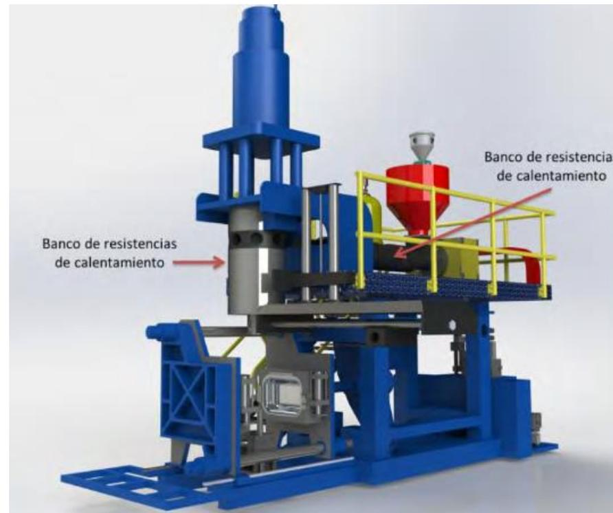
Fig. 11 Imagen con detalle de la Sopladora
