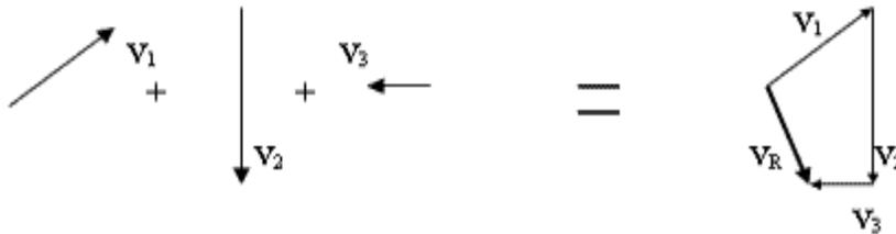
$$V_R = V_1 + V_2 + V_3 : V_R \text{ es el vector resultante destacado con línea gruesa.}$$
