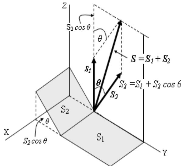
Figura Terreno compuesto por una parte plana y otra inclinada
