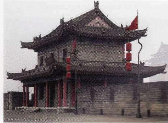
**Cubierta de armadura cruzada.** Cubierta de pabellón compuesta de varios niveles, algunos de los cuales incluyen en el mismo plano cubiertas perpendiculares entre sí
