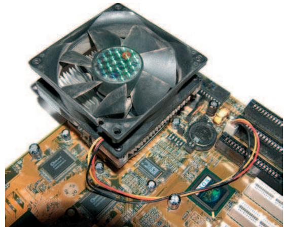
**Fig. 7.9.** *Fijamos el disipador y el ventilador al microprocesador.*
