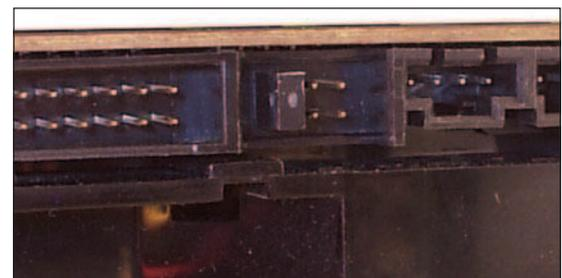
Fig. 7.15. Establecemos el carácter maestro o esclavo mediante los jumpers.
