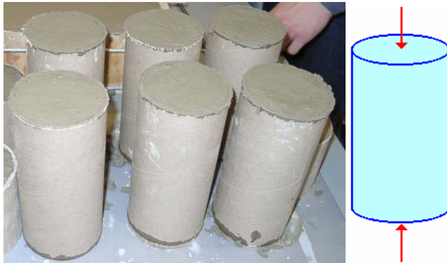
Figura 1.27: Muestras cilíndricas de hormigón para ensayos de compresión estándar.
