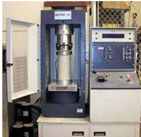
Figura 2.10: Prueba de resistencia a la compresión del hormigón.
