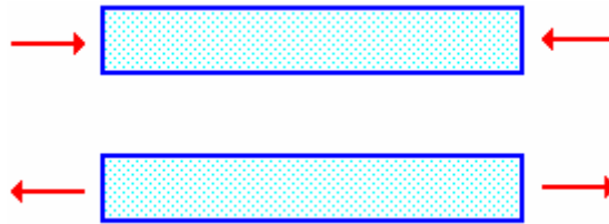
Figura 11.1: Elemento estructural sometido a compresión y tracción.
