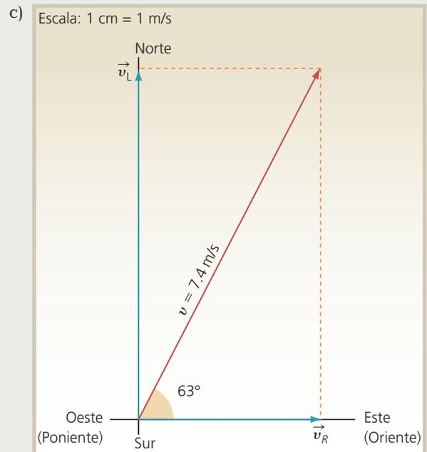
Como puede observarse, la velocidad de la lancha es de  $\mathbf{7.4 \text{ m/s}}$  con un ángulo de  $\mathbf{63^\circ}$  en dirección **noreste**.
