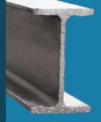
El perfil estructural IPN tiene sección en forma de doble T, con unas proporciones aproximadas de dos a uno entre altura y ancho. Las caras exteriores de sus alas son perpendiculares al alma mientras que las interiores tienen una inclinación de un 14% (mayor que la de los perfiles UPN), disminuyendo su espesor conforme se acerca hacia los bordes. Con las uniones entre las caras interiores de las alas y las del alma redondeadas, son muy utilizados para dinteles, soportes y pilares.
