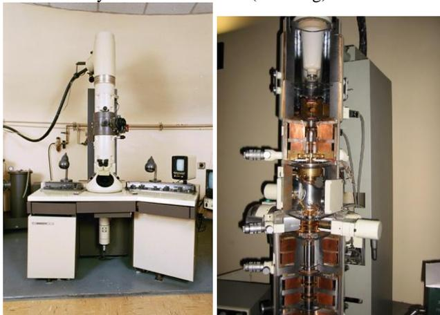
Figura microsc. 30. Fotografía de un microscopio electrónico de transmisión.
