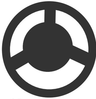
Figura microsc. 18. Esquema que muestra la manera de fabricar un diafragma para producir campo oscuro en un microscopio fotónico.
