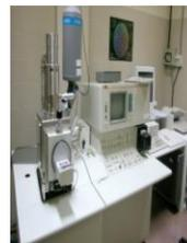
El microscopio genera imágenes llamativas de objetos tridimensionales con gran profundidad de foco y puede resolver detalles en un rango de 2 a 20 nm.
