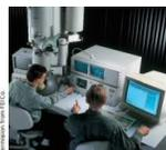
En principio, similar a un microscopio óptico, pero emplea un haz de electrones en lugar de un haz de luz, y bobinas magnéticas para enfocar el haz en lugar de lentes de cristal.
