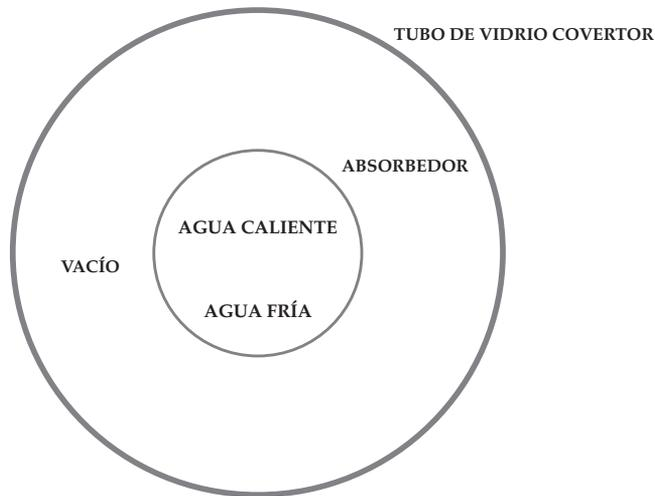
Figura 16. Corte transversal del tubo al vacío del calentador solar.
