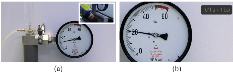
Figure 4. (a) Manomètre et Volant du contrôle; (b) Pression maximale de 50 bar.
