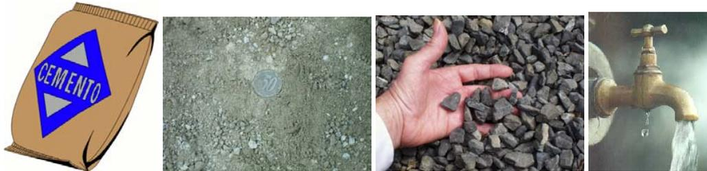
*Figura 1.1: Componentes del hormigón.*
