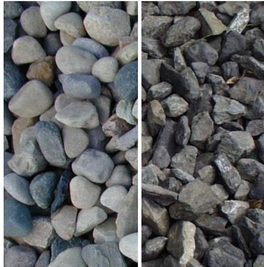
**Figura 2.9:** Agregado grueso natural y agregado grueso triturado.
