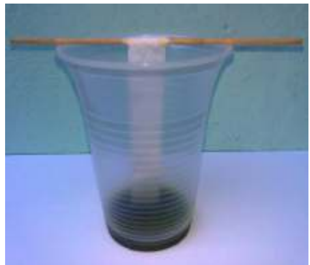
Figura 12. Cromatografía sobre papel utilizando un vaso de plástico transparente y un palito para sujetar la tira de papel.
