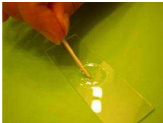
Figura 15. Colocación de la muestra en el portaobjetos.
