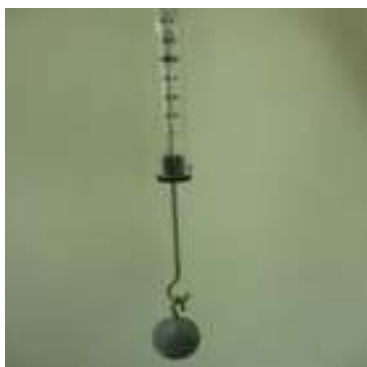
Figura 1. Determinación del peso real de la muestra.
