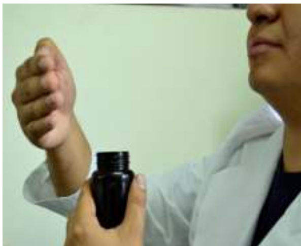
Figura 1. Forma correcta de detectar el olor de una sustancia.
