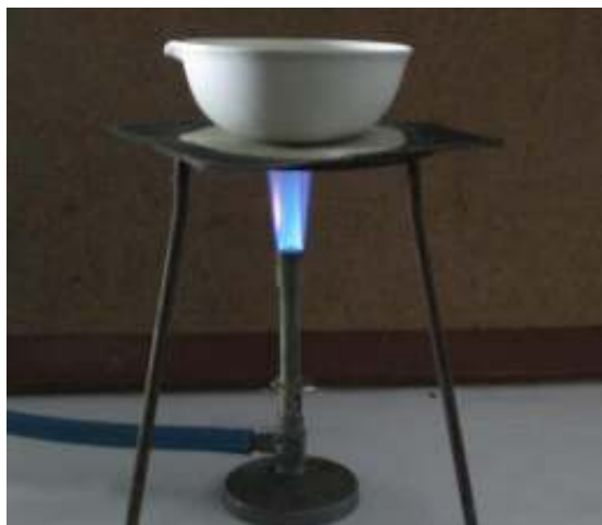
Figura 4. Evaporación de la mezcla contenida en la cápsula de porcelana.
