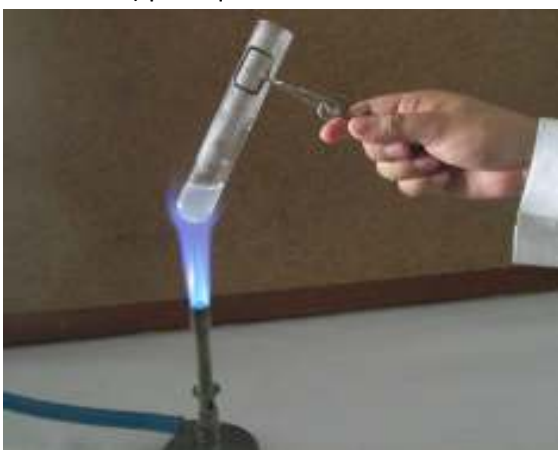
Figura 1. Calentamiento directo del tubo de ensayo.
