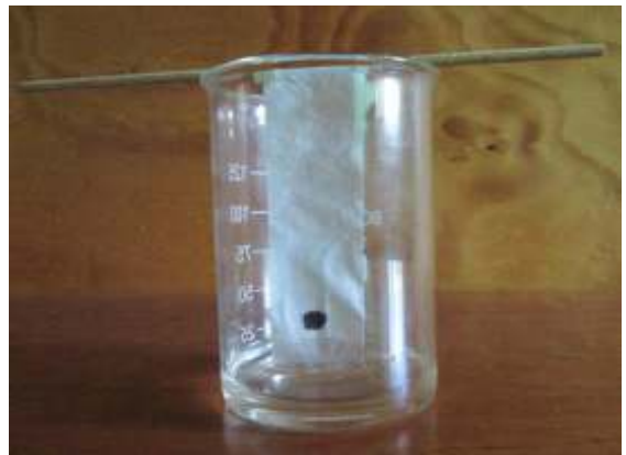
Figura 7. Colocación de la tira de papel filtro en el frasco.
