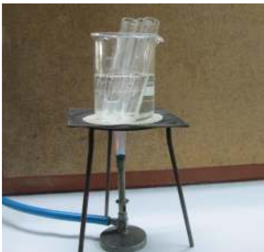
Figura 1. Calentamiento de la solución contenida en los tubos de ensayo en baño de maría.
