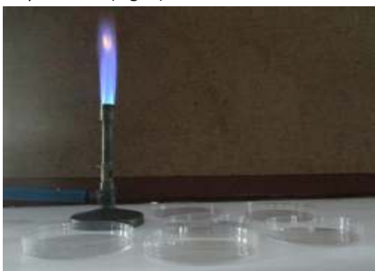
Figura 1. Secado de las cajas de Petri en las cercanías de un mechero encendido.
