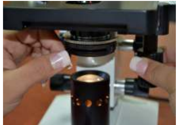
Figura 8. Apertura del condensador.
