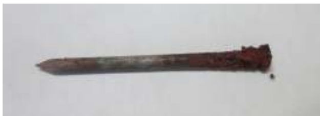
Figura 3. Cobre depositado sobre la parte del clavo que estuvo sumergida en la solución de sulfato de cobre (II) pentahidratado.
