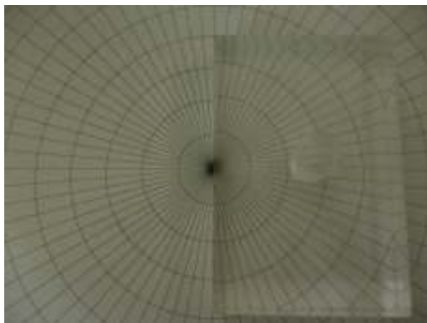
Figura 2. Pieza de vidrio con el borde sobre el eje x del papel polar.
