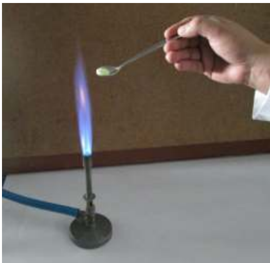
Figura 3. Combustión de fósforo en una cuchara de combustión.
