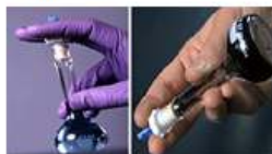
Figura 5. Forma de agregar la solución concentrada en el balón volumétrico para que se homogenice.
