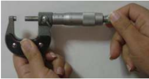
Figura 4. Forma correcta de utilizar el micrómetro.
