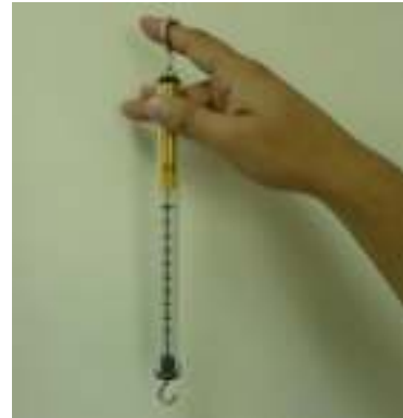
Figura 11. Medición del peso utilizando dinamómetro.
