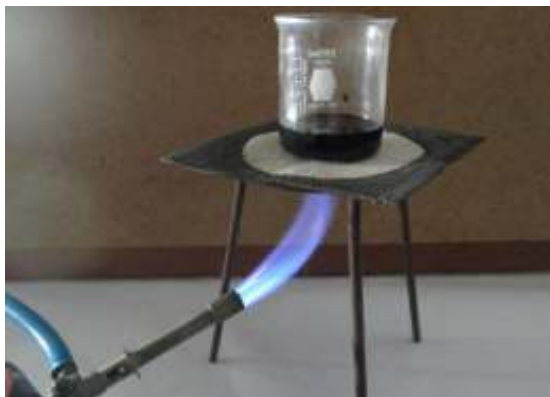
Figura 2. Flameado del beaker con la llama del mechero.
