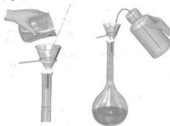
Figura 6. Forma de verter la solución al balón volumétrico.
