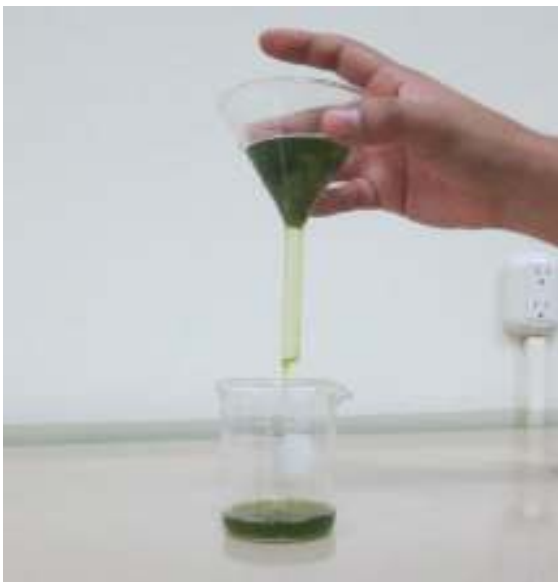
Figura 2. Colección del filtrado en un beaker de 150 mL.
