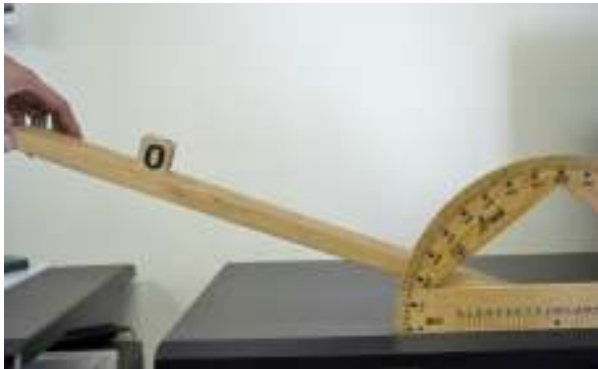
Figura 3. Inclinación de la base hasta que el objeto comienza a deslizarse.
