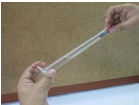
Figura 14. Forma correcta de introducir la muestra metálica en la probeta.
