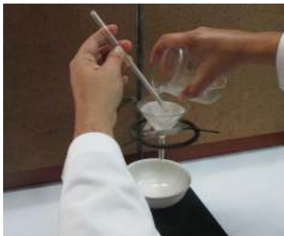
Figura 3. Forma correcta de verter la solución sobre el papel filtro.
