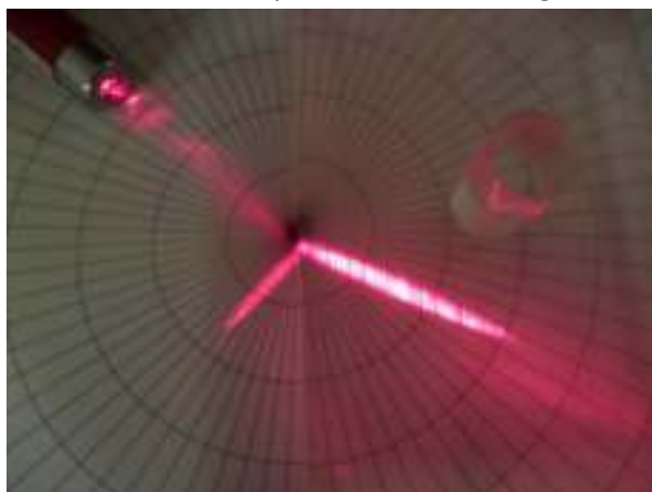
Figura 3. Incidencia de un rayo láser rojo con un ángulo de 45^\circ .
