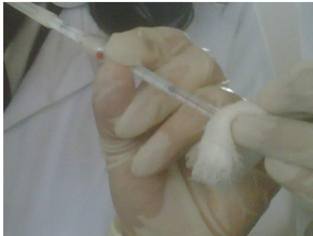
3. Se quita con cuidado el tubo de aspiración de goma y la pipeta se sujete entre el dedo pulgar y medio colocado en ambos extremos, sometiéndola a una agitación horizontal e inclinada durante 2 a 3 minutos. Más cómodo resulta obturar los extremos con unos tapones de goma y colocarla en un agitador; a tal fin sirve la perla de vidrio situada en la ampolla de la pipeta, que facilita una mezcla fácil, y rápida de la solución con la muestra de sangre.
