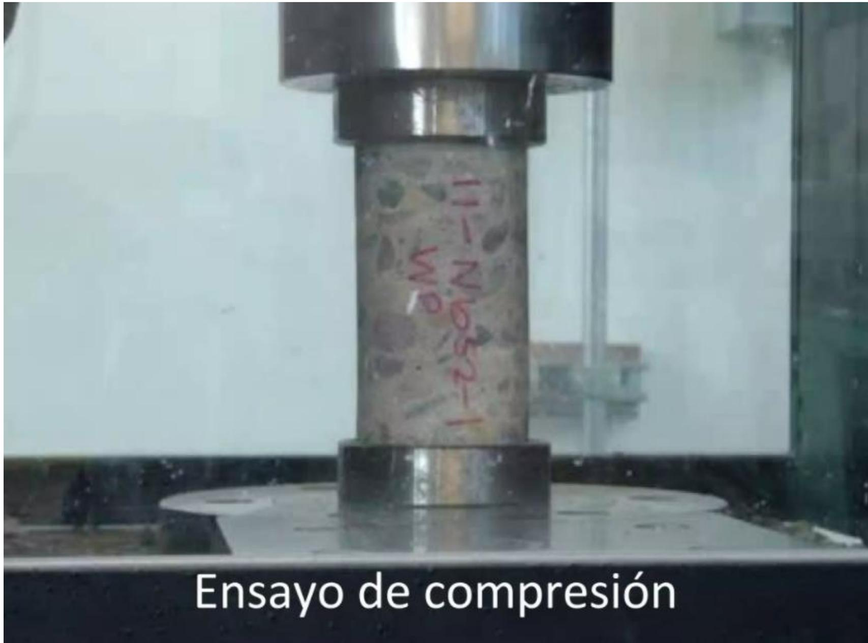
Ensayo de compresión
