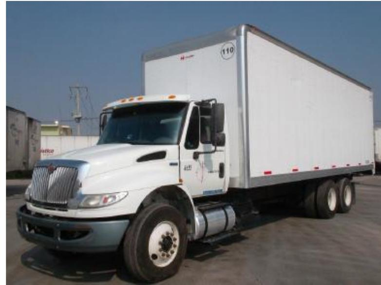
Presenta dos ejes con una separación de 1.2 m, donde ambos ejes tienen la misma carga
