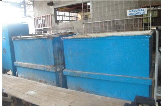
**Pasivado:** En este proceso las piezas galvanizadas se sumergen en tanques que contienen una solución de agua más el agente químico Cromatizado B7 dando un color azulado) y Cromatizado B12 dando un color amarillo tornasol, formándose una película pasivante que protege de una manera muy efectiva contra la corrosión.
