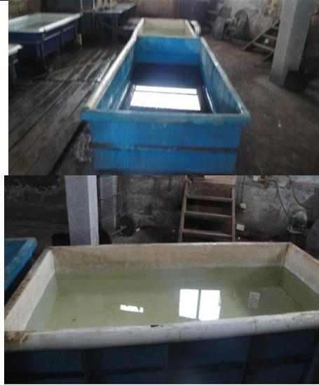
**Galvanizado y tropicalizado:** Es un proceso electrolítico a base de componentes de zinc y sosa caustica. Sirve para proteger de la corrosión a partes y piezas metálicas como pernos, rodela; también se presta servicios externos.
