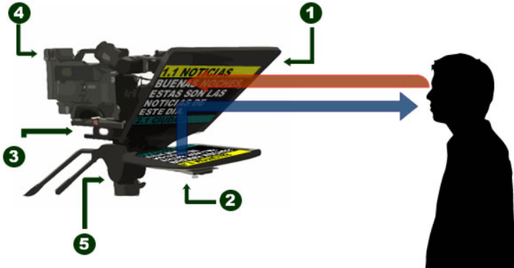
Teleprompter de Cámara 1.-Espejo Semitranslucido 2.-Monitor 3.-Base para cámara 4.-Cámara
