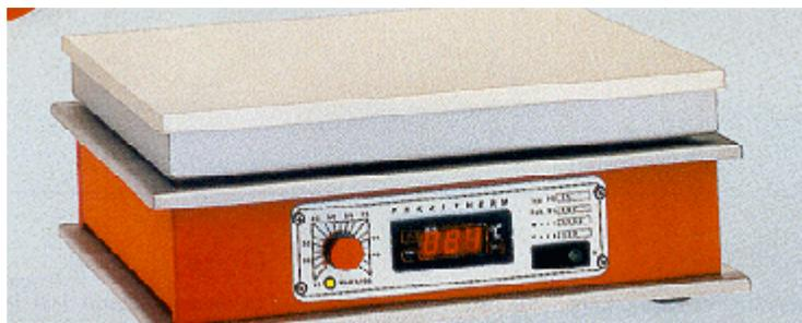
**Figura 1.3.Y. Plancha de calentamiento**
