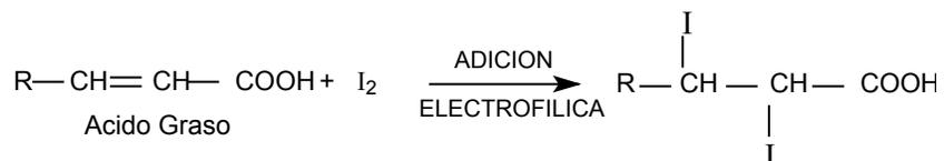
El yodo en exceso (que no se adicionó a los dobles enlaces) se valora entonces por retroceso con solución estandarizada de  $\text{Na}_2\text{S}_2\text{O}_3$  en presencia de almidón como indicador hasta desaparición del color azul, según todas las consideraciones ya explicadas con anterioridad.
