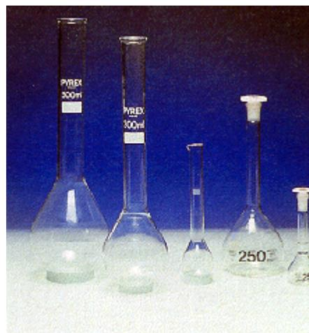
**Figura 1.3.E.****Matraces aforados contruidos de vidrio****Probetas graduadas:**
