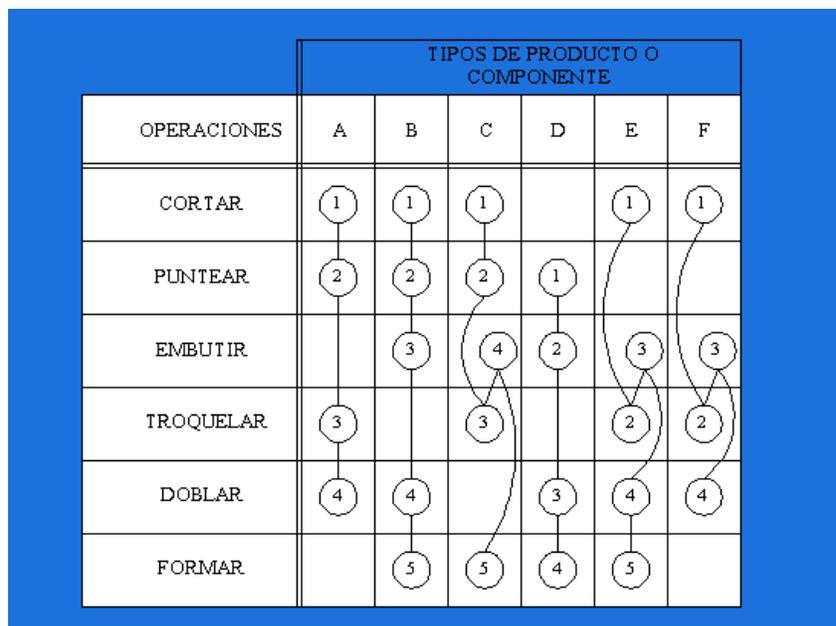
Figura 2.5 Ejemplo de Diagrama Multiproducto
