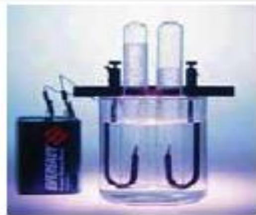
▲ **Figura 1.7** El agua se descompone en sus elementos constituyentes, hidrógeno y oxígeno, cuando se hace pasar una corriente eléctrica directa a través suyo. El volumen de hidrógeno (derecha) es el doble que el volumen de oxígeno (izquierda).
