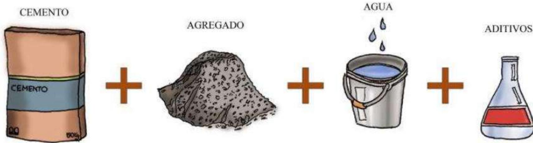
Figura 12: Componentes del hormigón.
