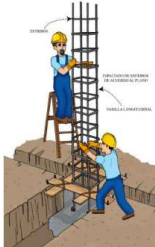
Figura 74: Armado de varillas de acero de columnas
