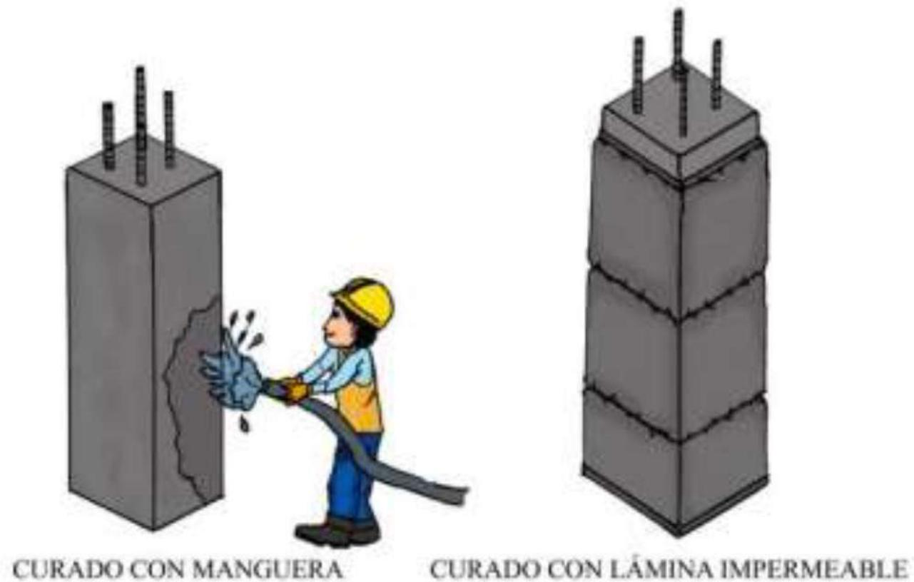
Figura 21: **Curado del hormigón**
