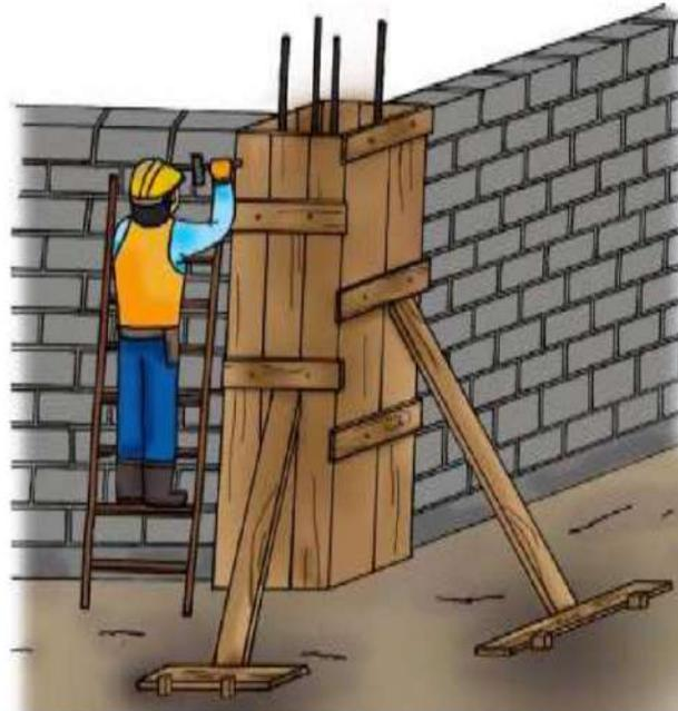
Figura 77: Encofrado de columnas
