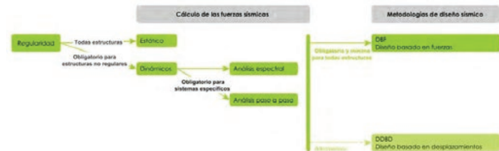
Figura 34 : Esquema simplificado de determinación de las fuerzas sísmicas laterales y métodos de análisis de la NEC-SE-DS
