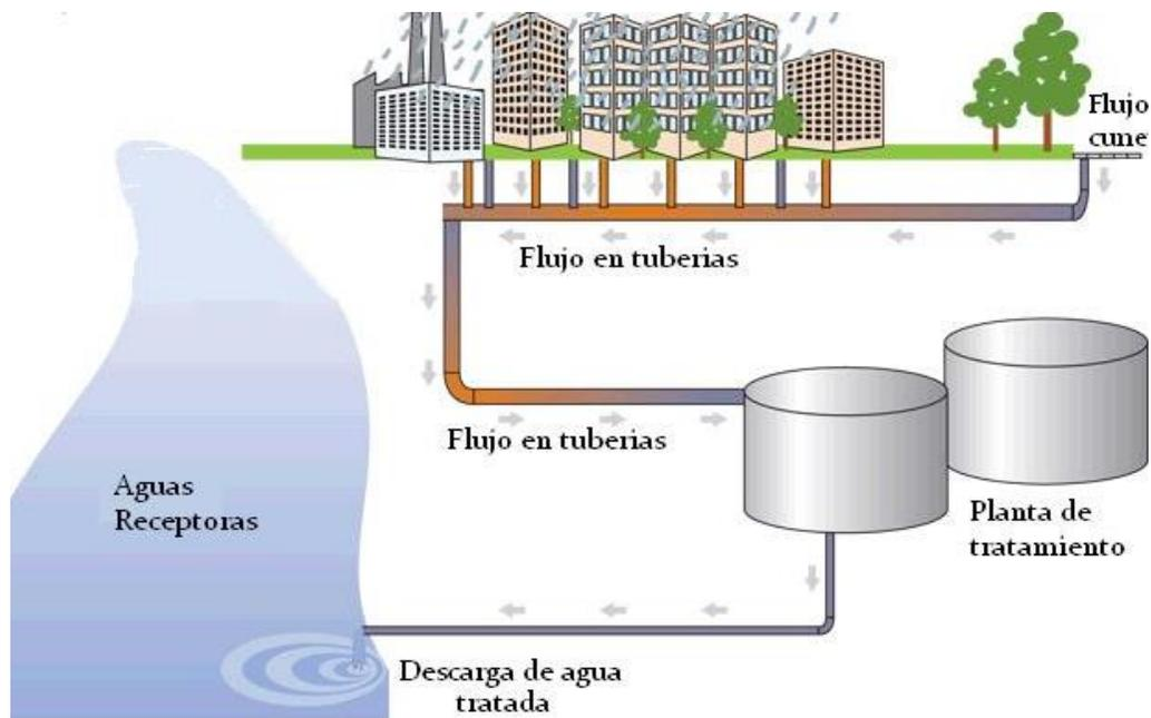
**Gráfico – Esquema general de un sistema de alcantarillado sanitario**
