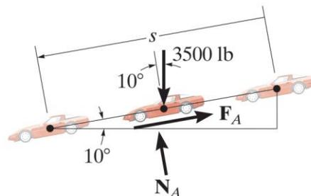
El peso, 3500 lb, es desplazado  $s \text{ sen } 10^\circ$  y efectúa trabajo positivo (la fuerza peso y el desplazamiento tienen la misma dirección). La fuerza de fricción  $F_A$  efectúa trabajo externo cuando se considera que sufre un desplazamiento  $s$ . Este trabajo es negativo ya que ocurre en la dirección opuesta al desplazamiento (en contra del sistema). Aplicando la ecuación de equilibrio normal al camino, tenemos
