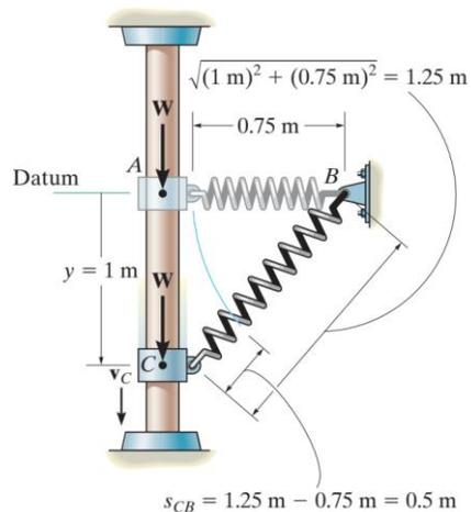
Cuando el collar está en  $C$ , la energía potencial de gravedad es  $-(mg)y$ , pues el collar está *debajo* del Datum, y la energía potencial elástica es  $\frac{1}{2}ks_{CB}^2$ . Aquí  $s_{CB} = 0.5 \text{ m}$ , lo cual representa el *elongamiento* en el resorte como se muestra en la figura arriba.
