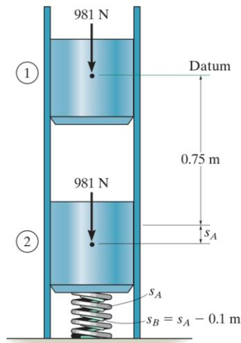
Cuando la energía cinética se reduce a cero ( $v_2 = 0$ ),  $A$  es comprimido una distancia  $s_A$  y  $B$  se comprime a una distancia  $s_B = s_A - 0.1$  m.
