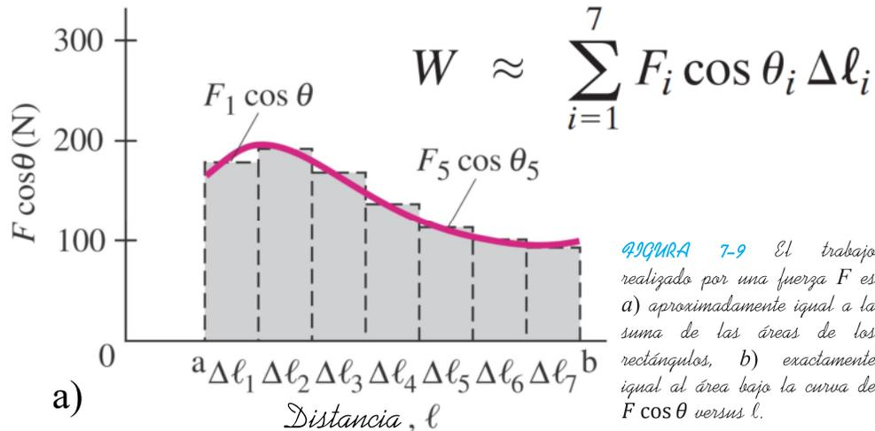
FIGURA 7-9 El trabajo realizado por una fuerza  $F$  es a) aproximadamente igual a la suma de las áreas de los rectángulos, b) exactamente igual al área bajo la curva de  $F \cos \theta$  versus  $l$ .
