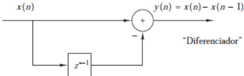
Este sistema se describe mediante las ecuaciones de entrada-salida
