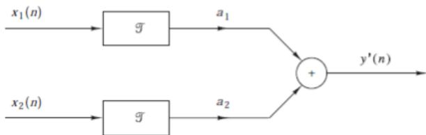
Representación gráfica del principio de superposición.  $\mathcal{T}$  es lineal si y sólo si  $y(n) = y'(n)$ .
