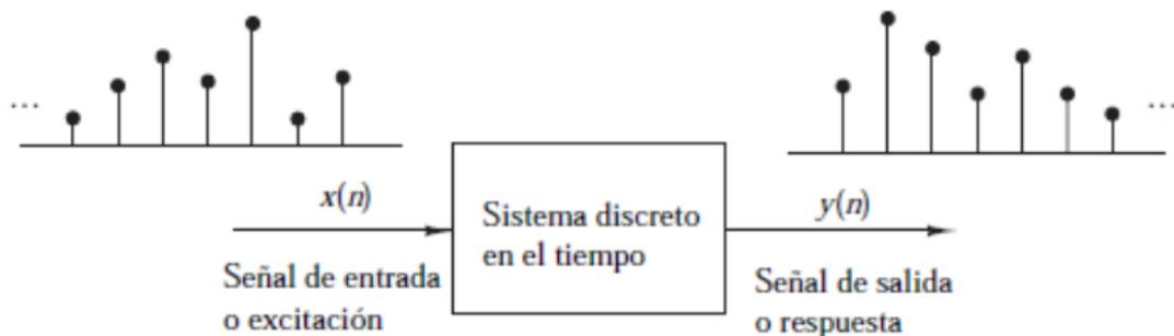
Diagrama de bloques de un sistema discreto en el tiempo.
