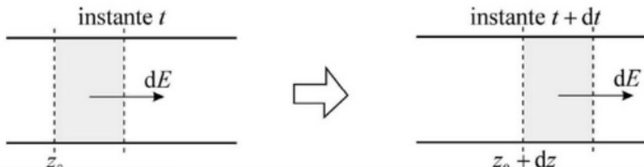
A continuación se calculará la velocidad de propagación de la energía para nuestro modelo de línea dispersiva. Considerando que sólo existe onda incidente, la potencia transmitida en un punto de la línea será:
