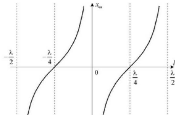
Nuestro último ejemplo de aplicación consiste en una línea de transmisión de longitud  $\lambda/4$  a la frecuencia de trabajo, y en cuyo extremo conectamos una carga de impedancia arbitraria  $Z_L$  (ver Figura ).
