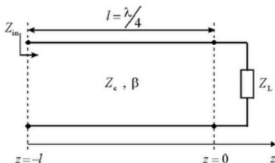
**Figura** Línea de transmisión de longitud  $\lambda/4$
