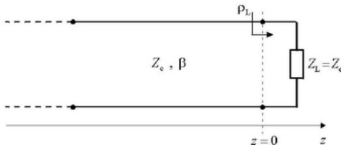
**Figura** Línea de transmisión terminada en una carga igual a su impedancia característica
