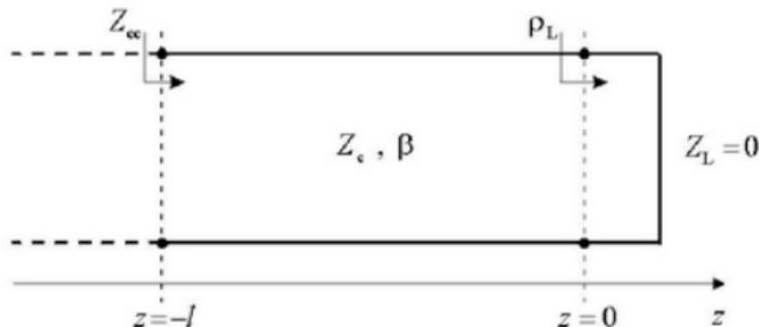
**Figura** Línea de transmisión terminada en cortocircuito
