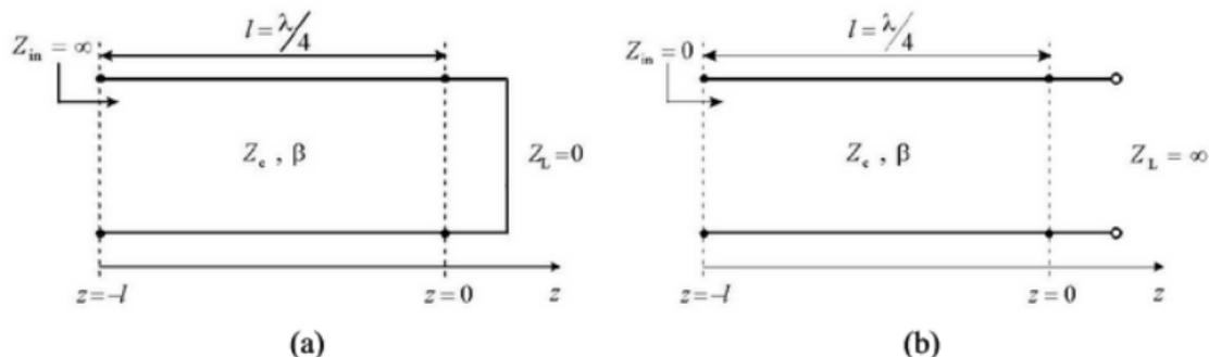
**Figura** *Inversor de impedancias en  $\lambda/4$  terminado en cortocircuito (a) y terminado en circuito abierto (b)*
