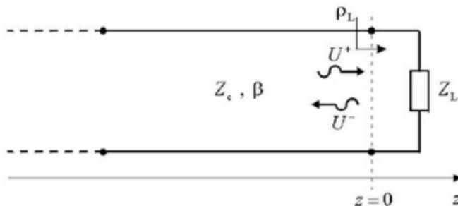
**Figura** Línea de transmisión terminada en una carga de valor  $Z_L$
