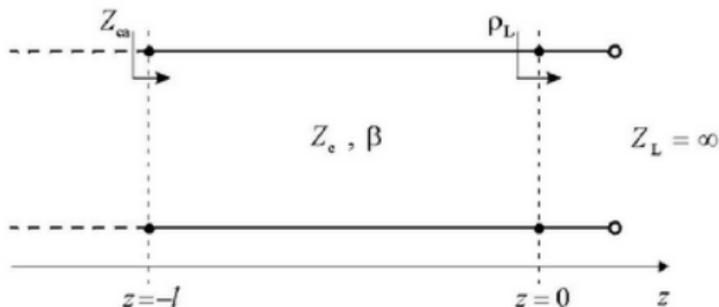
**Figura** Línea de transmisión terminada en circuito abierto
