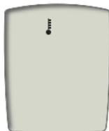
La temperatura es superior o inferior al rango correcto para el medidor (50 – 104°F). Vaya a un lugar con una temperatura de entre 50 y 104°F, y deje que el medidor se enfríe o caliente lentamente a temperatura ambiente. No caliente ni refrigere el medidor artificialmente. Vea "Condiciones de prueba adecuadas" en la página 28.
