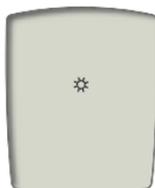
El ambiente en el que realiza la prueba está demasiado iluminado. *Repita la prueba en un ambiente más oscuro (al abrigo de la luz solar directa) con una tira reactiva nueva.*
