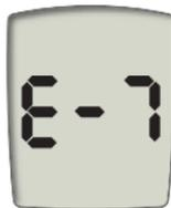
Ha ocurrido un error al efectuar la prueba, o existe una interferencia electromagnética. *Repita la prueba. Si aparece el mismo mensaje, aléjese de las fuentes de interferencias y repita la prueba.*
