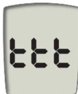
La temperatura es superior o inferior al rango correcto para el medidor. *Vaya a un lugar con una temperatura de entre 50 y 104°F, deje que el medidor se enfrie o caliente lentamente a temperatura ambiente y repita la prueba. Si obtiene un resultado con símbolo de termómetro, el resultado pueda ser incorrecto. No caliente ni refrigere el medidor artificialmente.*
