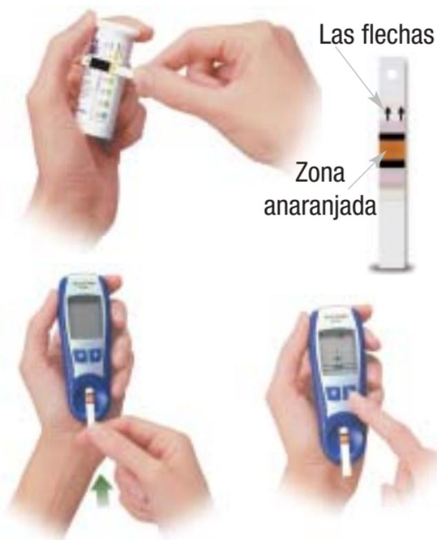
*Para ejecutar una prueba de control, Vd. necesita el medidor, una tira reactiva, un frasco de solución de control y un paño o una toallita de papel.*
