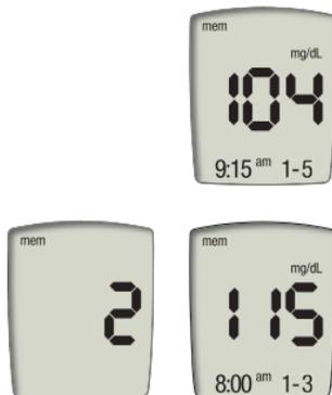
1. En el medidor apagado, presione y suelte **M**. Aparece el resultado más reciente junto con la fecha y hora.
