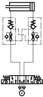
La combinación de las funciones consiste en la combinación de una válvula antirretorno y una válvula antirretorno desbloqueable. Mientras está aplicada la señal proveniente de la conexión neumática 21, se estrangula el escape. Si la válvula no recibe señal de pilotaje, bloquea el escape. En el sentido del caudal, al aire comprimido fluye a través a través de la válvula antirretorno sin estrangulación.
