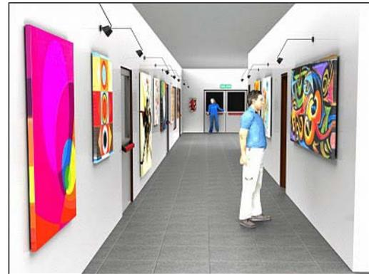
En la proyección en perspectiva se generan visuales que convergen en un punto común conocido como **punto de fuga** y por lo cual se genera una sensación de profundidad en el dibujo.
