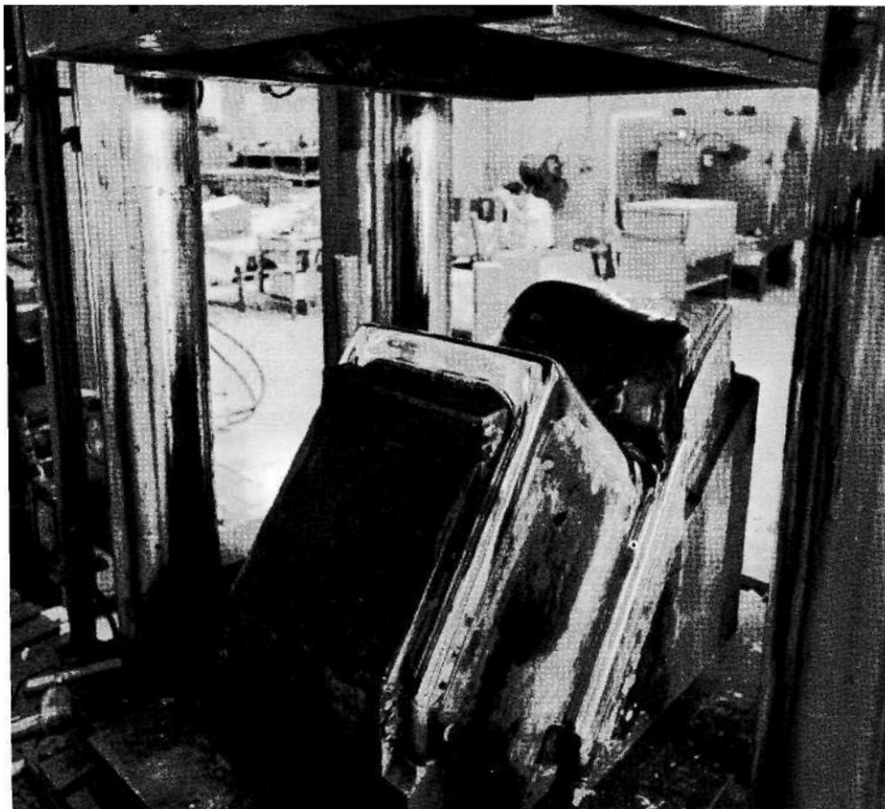
El molde de acero para el moldeo de una silla de poliéster reforzado
