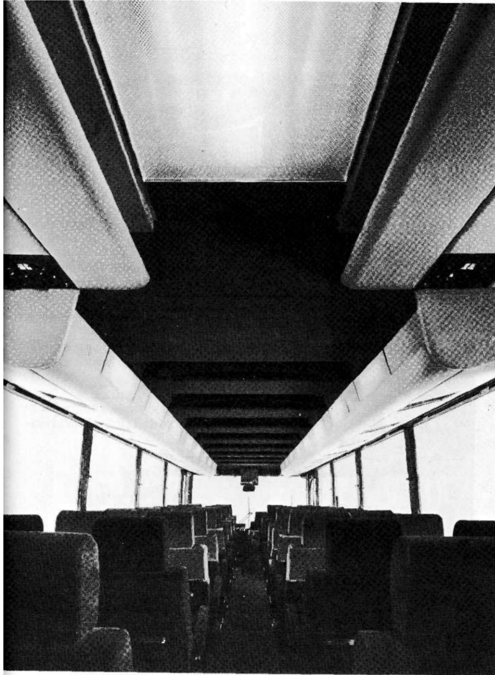
El interior del autocar donde se advierte en seguida la máxima visibilidad. El efecto túnel es anulado mediante repisas transversales y la elevación del techo en la parte posterior del vehículo
