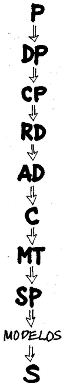
De la experimentación, indicada en el esquema con S, pueden surgir modelos, realizados para demostrar posibilidades matéricas o técnicas que se utilizarán en el proyecto
