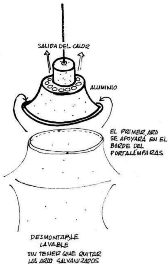
Se diseña un portalámparas de aluminio, que cumplirá la función de sostener la bombilla y llevar el primer aro del tubo. La bombilla más adecuada resulta ser una con reflector de espejo de 100 W.
