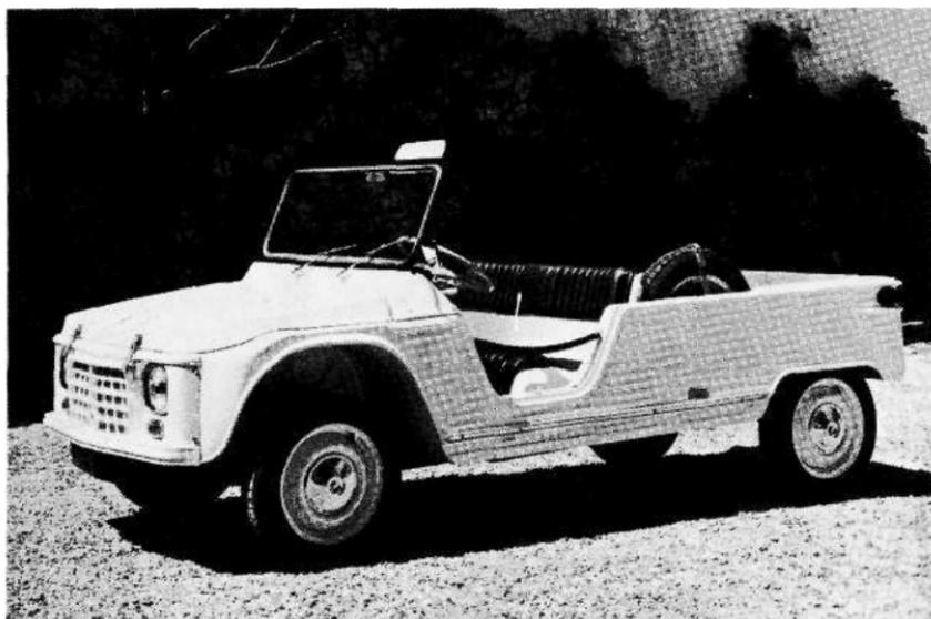
Carrocería para el Mehari Citroen de ABS termoformado
