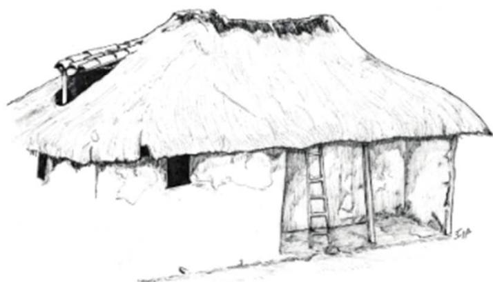
Imagen 34. Edificación con cubierta con revestimiento de paja.
