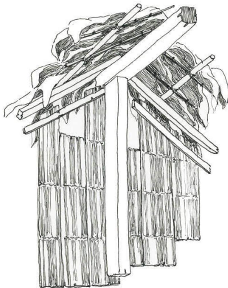
Imagen 35. Edificación con cubierta con revestimiento de bijao.
