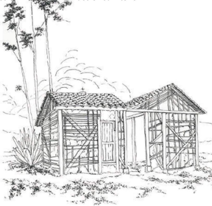
Imagen 25. Estructura para conformar muros de bahareque.
