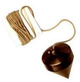
E. Cordel. Llamada así a una cuerda delgada de gran resistencia que es empleada para determinar la rectitud de una obra.
