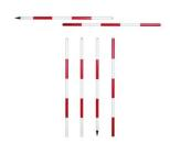
C. Juego de fichas. Varillas de metal de unas 50 cm de altura con punta en la parte inferior y un circulo en la parte superior, son empleadas para determinar la distancia que se encuentra un punto de otro y también son usadas al inicio para amarrar el cordel y así determinar una línea recta.
