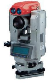
En este aparato se integra el teodolito óptico y el distanciometro, ofreciendo la misma linea de vista para el teodolito y el distanciometro, se trabaja mas rápido con este equipo, ya que se apunta al centro del prisma, a diferencia de un teodolito con distanciometro, en donde en algunos casos se apunta primero el teodolito y luego el distanciometro, o se apunta debajo del prisma, actualmente resulta mas caro comprar el teodolito y el distanciometro por separado.
