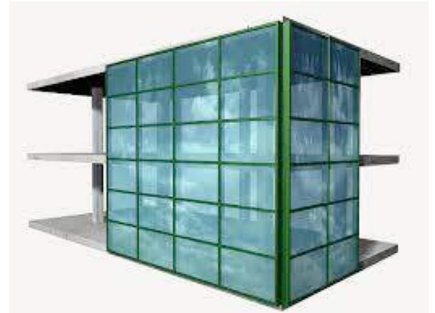
El muro cortina se compone básicamente los elementos resistentes que son montantes (elementos verticales) y travesaños (elementos horizontales) los cuales forman una retícula en la cual se incorporan los elementos denominados de relleno y los elementos practicables.
