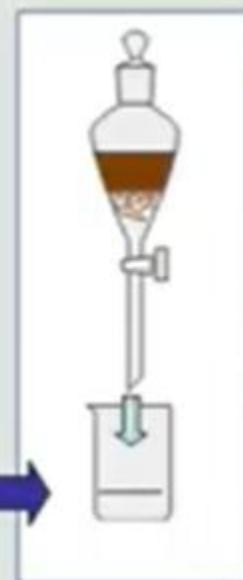
Lavado de la fase orgánica con disolución de hidróxido sodio y nueva separación de la fase orgánica
