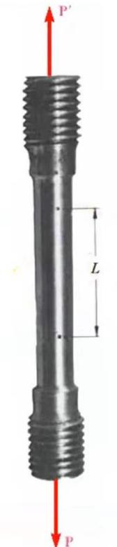
Analizamos una probeta, la cual jala de sus extremos mediante una fuerza de tensión céntrica. Se registra su alargamiento y deformación de su sección. Y se analiza mediante diagramas ESFUERZO - DEFORMACIÓN
