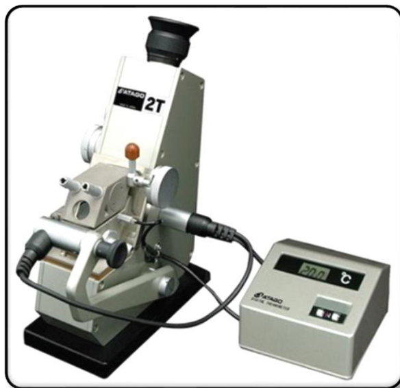
Figura 7.3. Refractómetro de Abbe con control de temperatura
