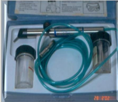
1, Arenado con óxido de aluminio, de 50 mm por 4 a 6 segundos para eliminar impurezas y promover porosidades (SOLO PARA METAL)
