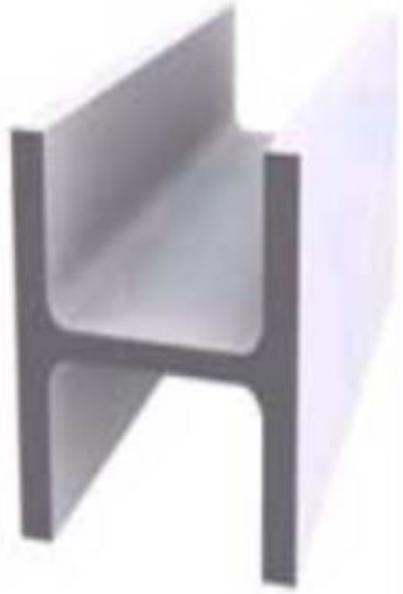
El perfil HEM es un producto laminado con una sección en forma de H. teniendo las caras exteriores e interiores de las alas son paralelas entre si y perpendiculares al alma, consiguiendo con ello un grueso constante y reforzado respecto a los perfiles HEB.
