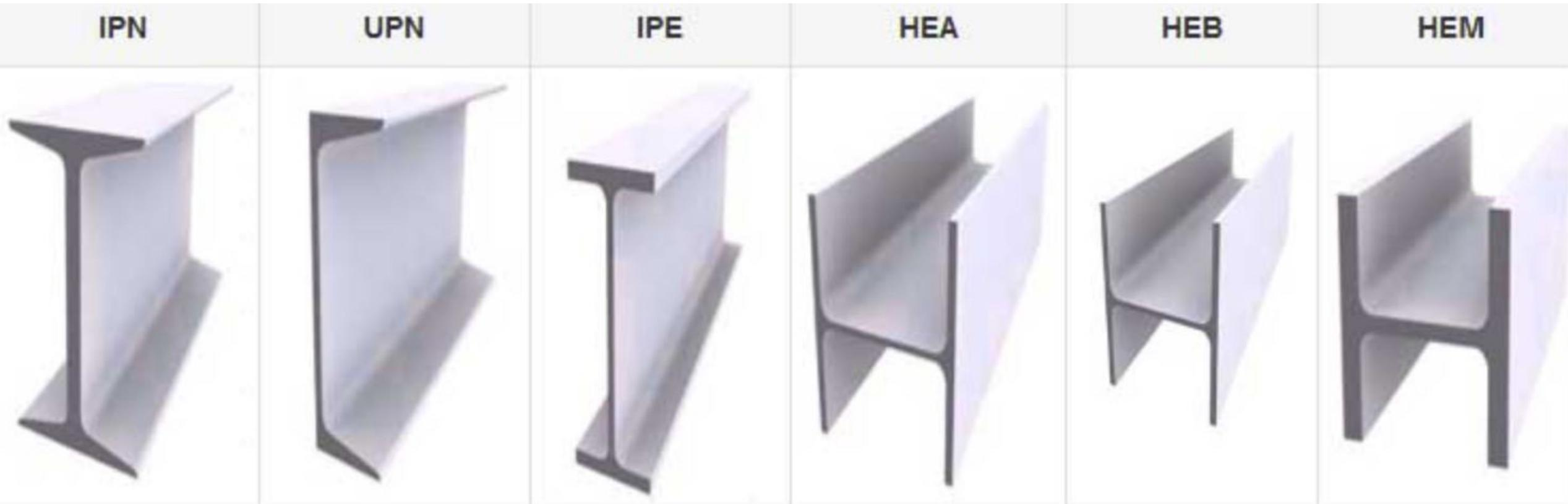
Los perfiles de acero se obtienen a partir del laminado de un tipo de acero ampliamente conocido como rolado. Este elemento de metal se manipula en caliente y se trabaja hasta obtener los distintos tipos de perfiles de acero que hoy en día conocemos.
