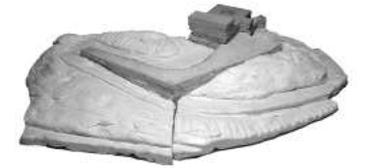
Este edificio-borde contiene la tierra del monte Gianicolo. La estructura consta de muros de hormigon armado que como costillas sujetan la tension del terreno. En el edificio se pueden notar dos partes. La primera contiene la entrada y la sala polifuncional. La segunda contiene la biblioteca dividida en dos niveles espacialmente relacionados entre ellas. Abajo de la biblioteca encontramos la zona residencial con viviendas que miran al paisaje a traves de balcones compartidos.
