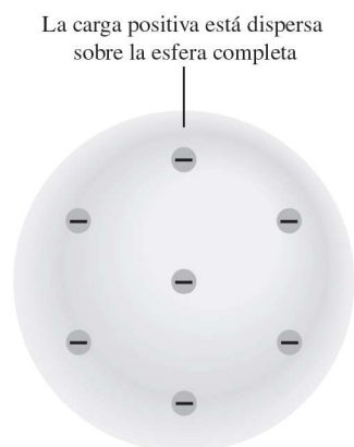
Figura 2.7 Modelo atómico de Thomson, conocido como el modelo del “pudín de pasas”, por su semejanza con un postre tradicional inglés hecho con pasas. Los electrones están insertos en una esfera uniforme con carga positiva.
