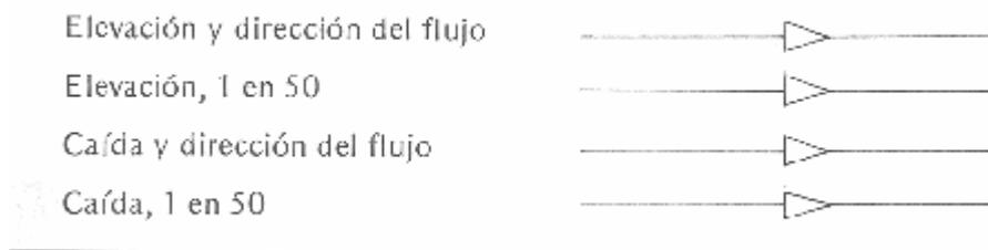
g) Las iniciales de las palabras: elevación, caída de arriba, de abajo, hacia arriba, hacia abajo, se usan para denotar la ruta de las tuberías verticales, así:
