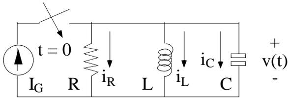
El circuito de la figura, en el que la fuente es continua y son datos las características de todos los elementos, ha permanecido mucho tiempo sin cambios antes del cambio de posición del interruptor. Una vez producido éste, ya no experimenta más cambios.
