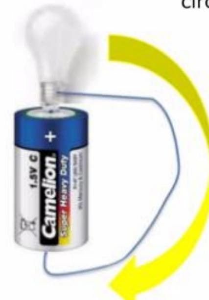
Esto se debe a que las conexiones se hicieron de manera que la corriente eléctrica pueda circular entre la pila a la ampolleta. En otras palabras, en este caso se armó un circuito eléctrico.
