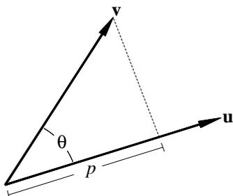
Figura 9: Proyección ( $p$ ) de un vector sobre otro.
