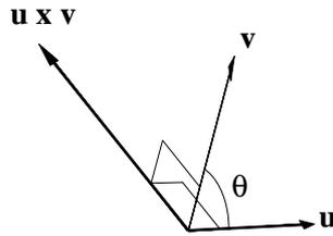
Figura 10:  $\mathbf{u} \times \mathbf{v}$  es un vector perpendicular a los vectores no paralelos  $\mathbf{u}$  y  $\mathbf{v}$ , y su dirección es tal que los tres vectores forman un sistema derecho.
